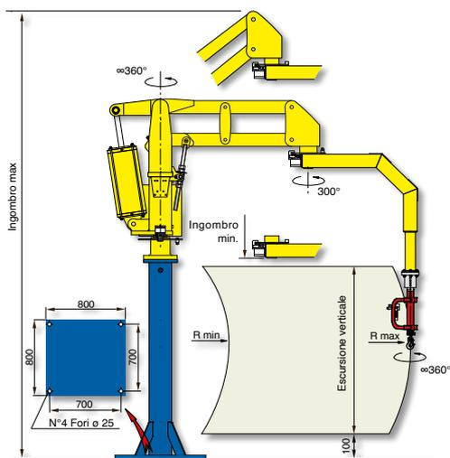
Versioni strutturali: su base fissa, su basamento autostabile di nostra fornitura opportunamente dimensionato, o con carrello autostabile motorizzato scorrevole lungo una semplice rotaia posta sul pavimento.
