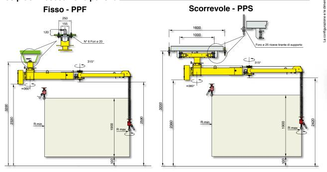
Alimentazione: aria compressa secca e non lubrificata min. 0,7÷0,8 MPa costanti
